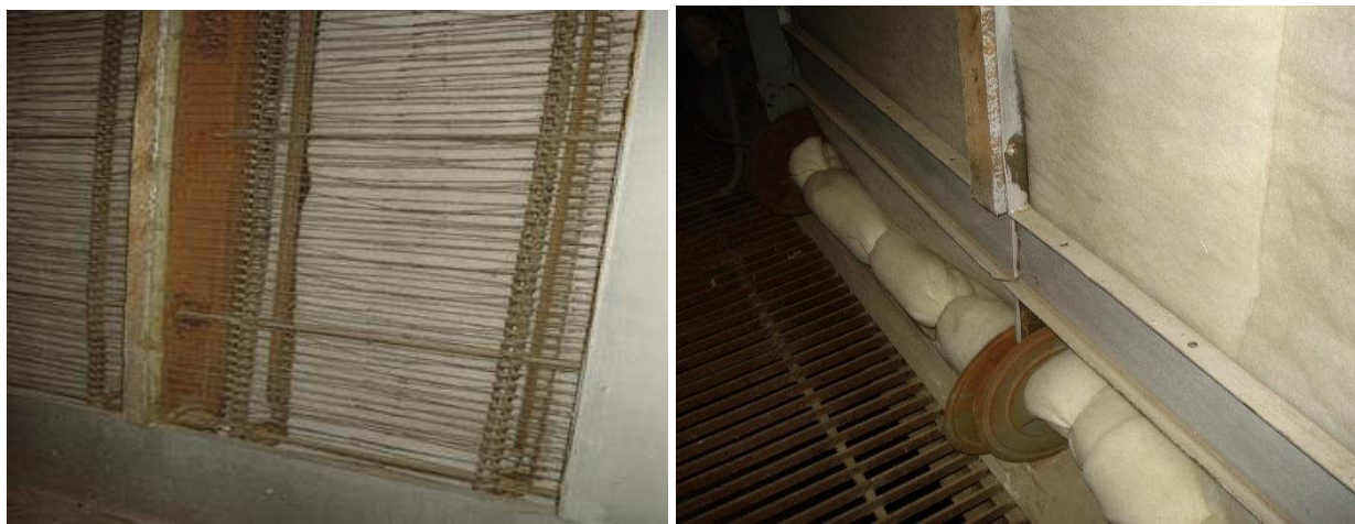
Рис.И2. Секции фильтра: а-каркас с цепным транспортером; б- катушки с фильтровальным материалом
