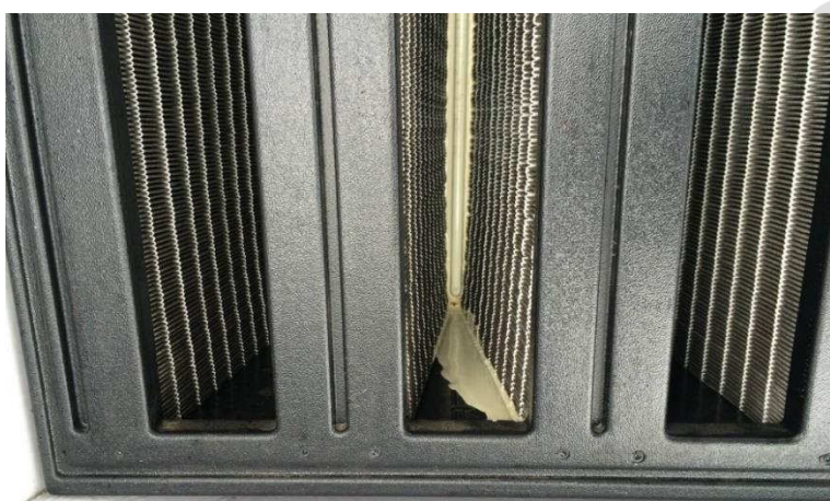
Рис.4.48. Некачественная герметизация и ее отсутствие в стыках фильтровального материала с рамкой в V-образных секциях кассетных фильтров
