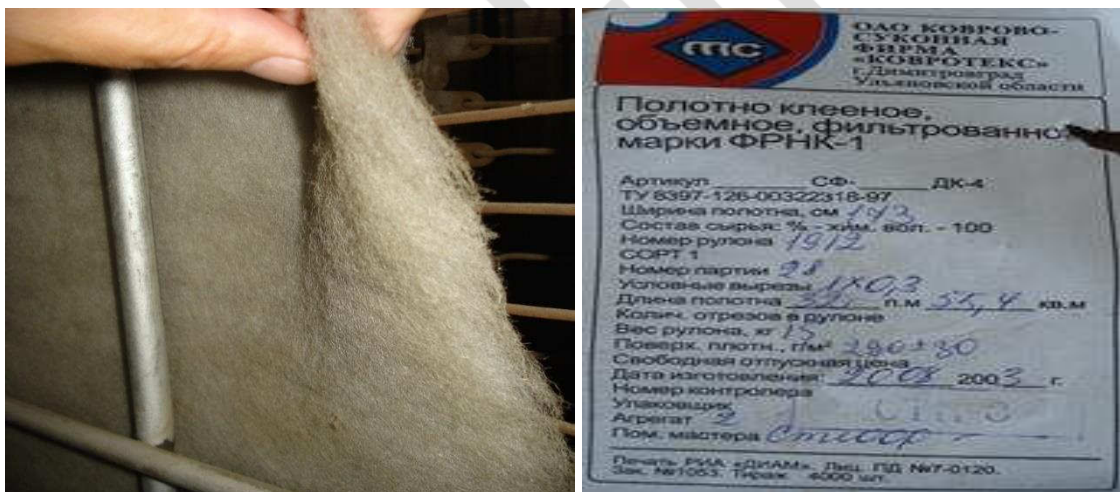
Рис.И1. Фильтровальный материал: а-внешний вид; б- характеристики материала
