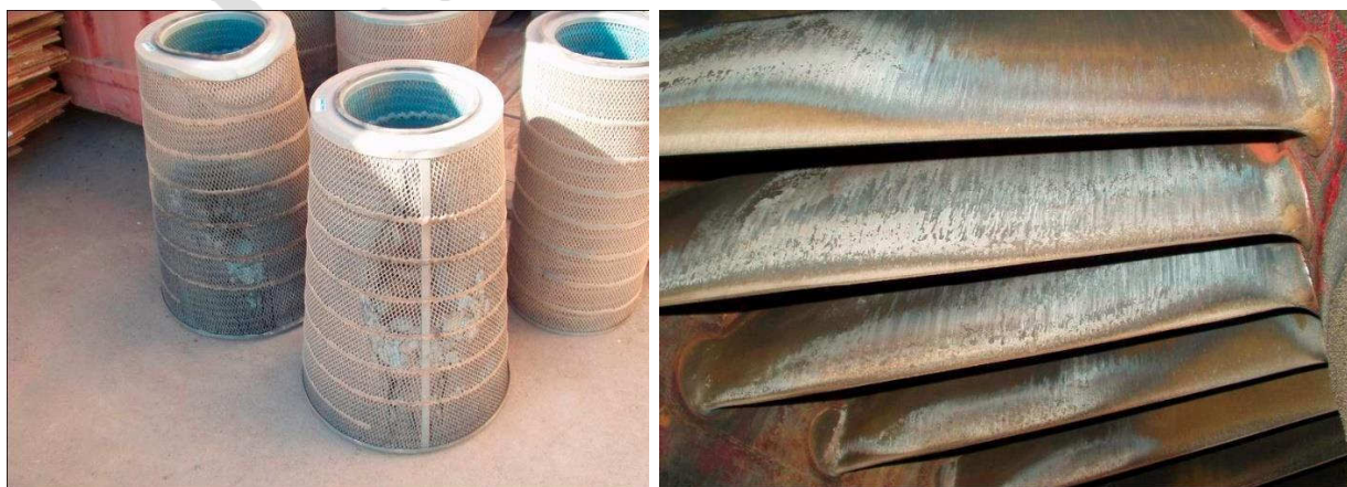
Рис.3.4. ГТУ V94.2А: а- импульсные фильтры; б- эрозийный износ лопаток компрессора
