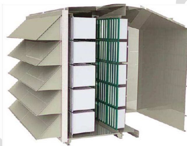
Рис.3.15. КВОУ с двумя ступенями очистки воздуха [7].
