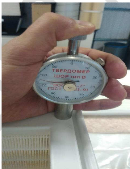
Рис.3.26. Определение твердости пластмассы дюрометром по Шору тип D
