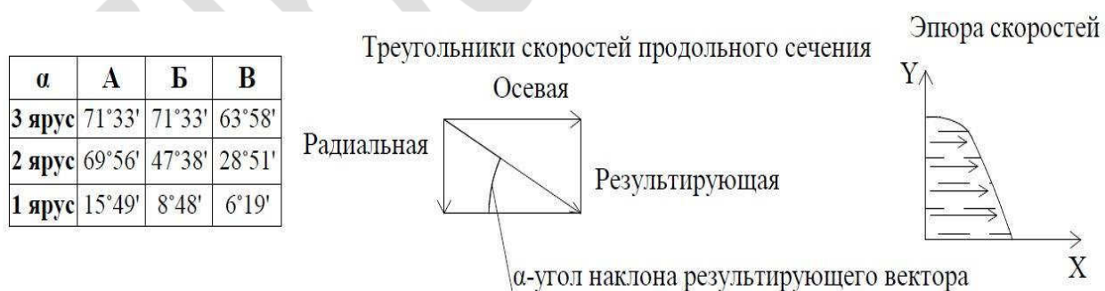
Рис.2.57. Обозначения векторов скоростей и углов поворота потока, эпюра скоростей по высоте КВОУ ГТУ
