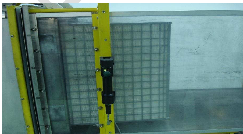
Рис.4.27. ФТО MVX класса F9 на испытательном стенде
