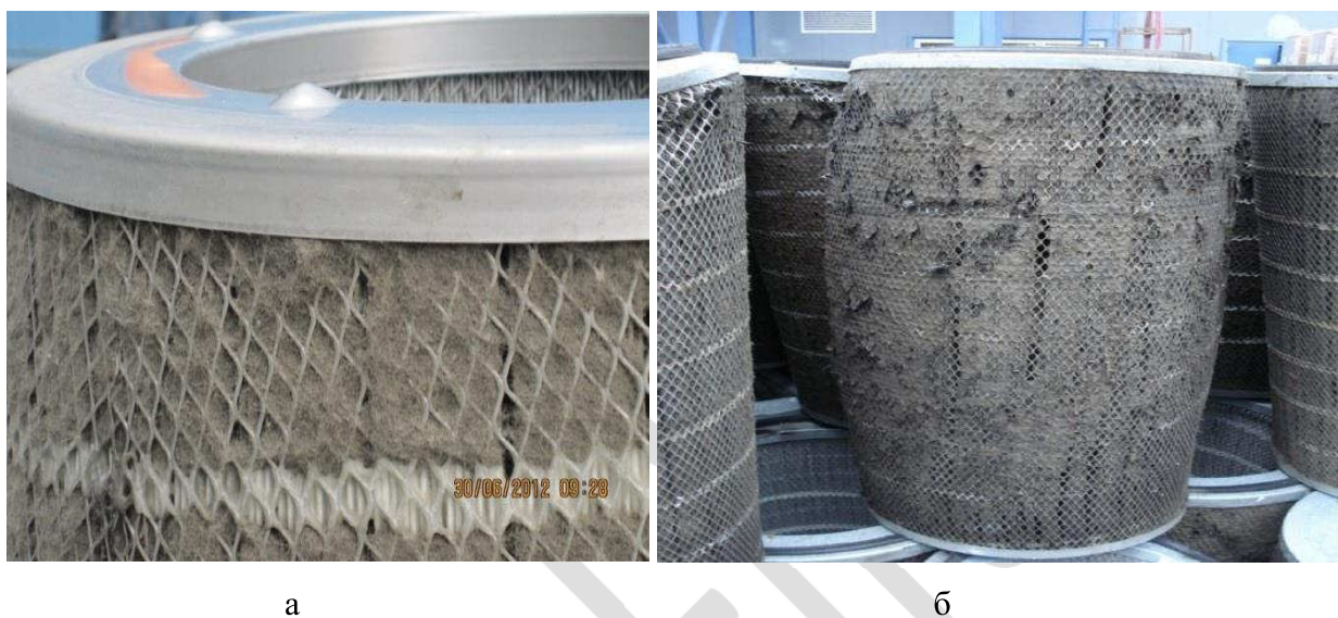
Рис. 3.9. Блокировка импульсных фильтров тополиным пухом: а- в Сургуте; б- в Шатуре.
