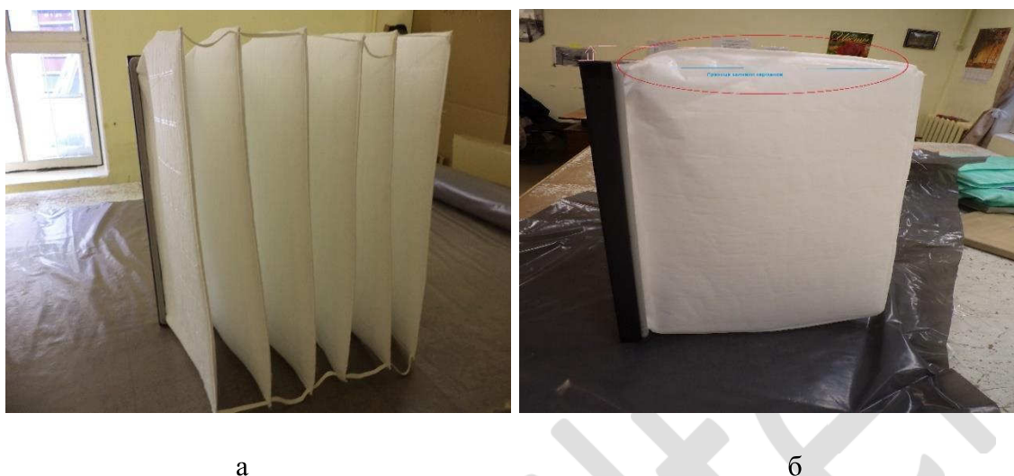
Рис.3 52. Фильтры: а- фиксация карманов лентой; б – карманы, выступают над рамкой
