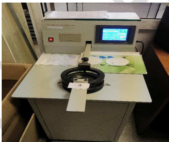
Рис.3.42. установке XHF-01C-A (Fabric Air Permeability Tester)
