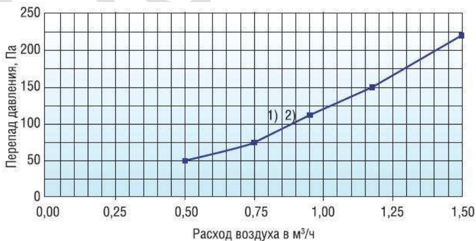
Рис.4.22. Графики начального перепада давления фильтра: 1- до; 2- после климатических испытаний
