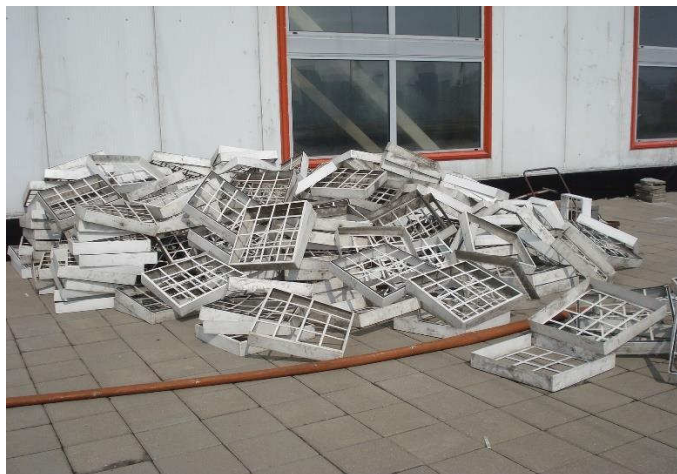
Рис.3.24. Поврежденные рамки фильтров коагуляторов Poret
