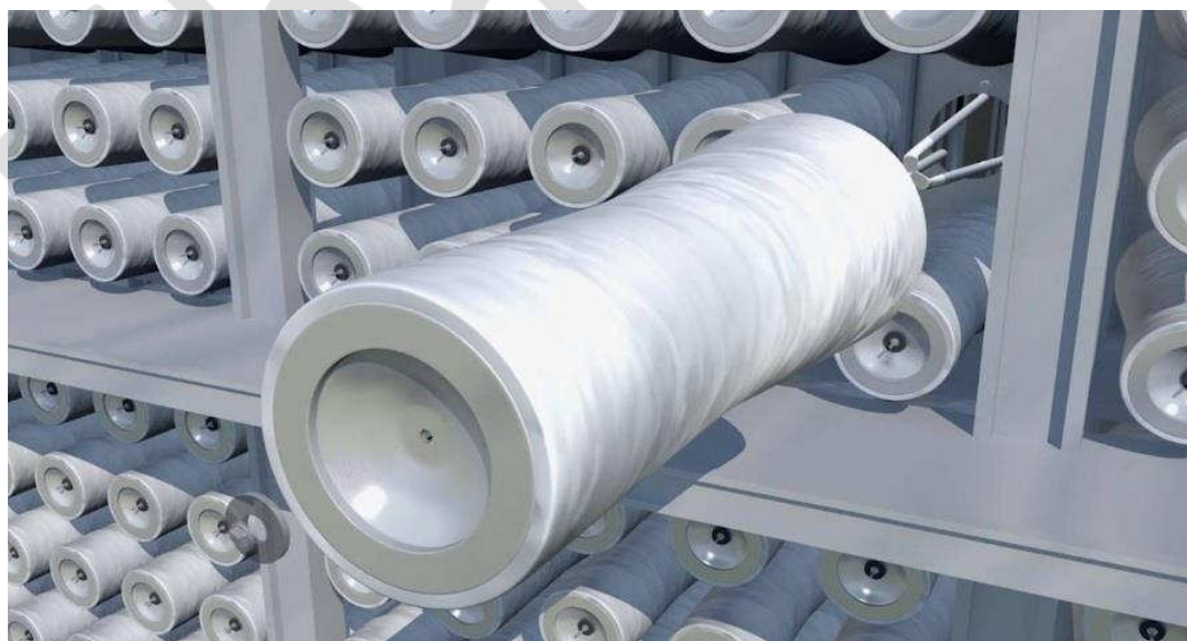
Рис.3.72. Цилиндрические фильтры компании Gore в КВОУ ГТУ ( clck.ru/33j5fuG )
