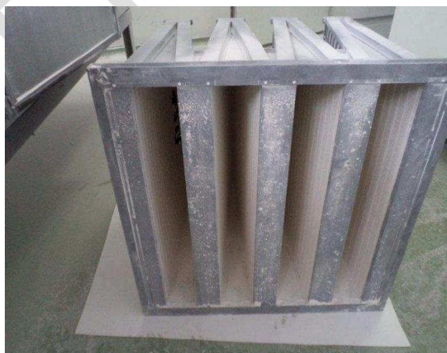
Рис.4.30. Фильтр MVX F9 после тестирования на разрыв
