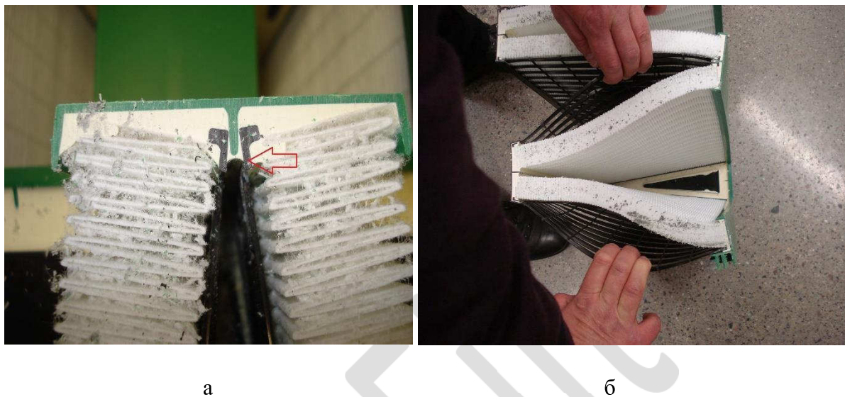
Рис.3.92. Пластмассовая защитная сетка кассетного фильтра шведской компании С: а- фиксация; б- проверка на прочность
