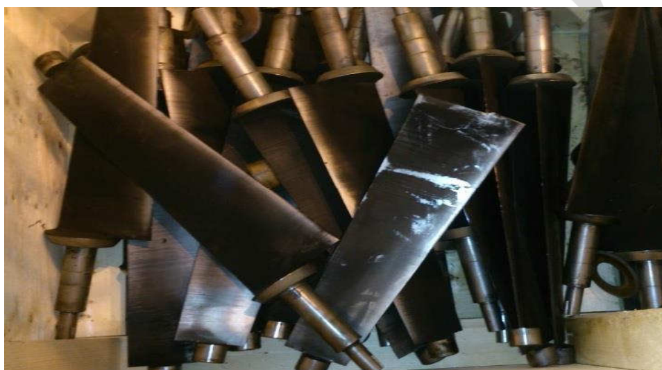
Рис. 3.10. Лопатки ВНА компрессора GE PG935FA Шатурской ГРЭС [6]
