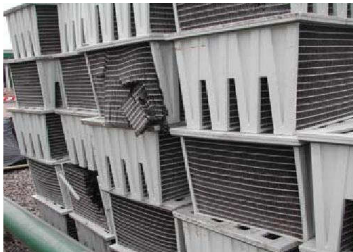
Рис.3.94. Массовое разрушение фильтров компании E с minipleat
