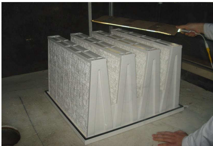
Рис.4.33. Тестирование фильтра E11-31/38 масляной нитью
