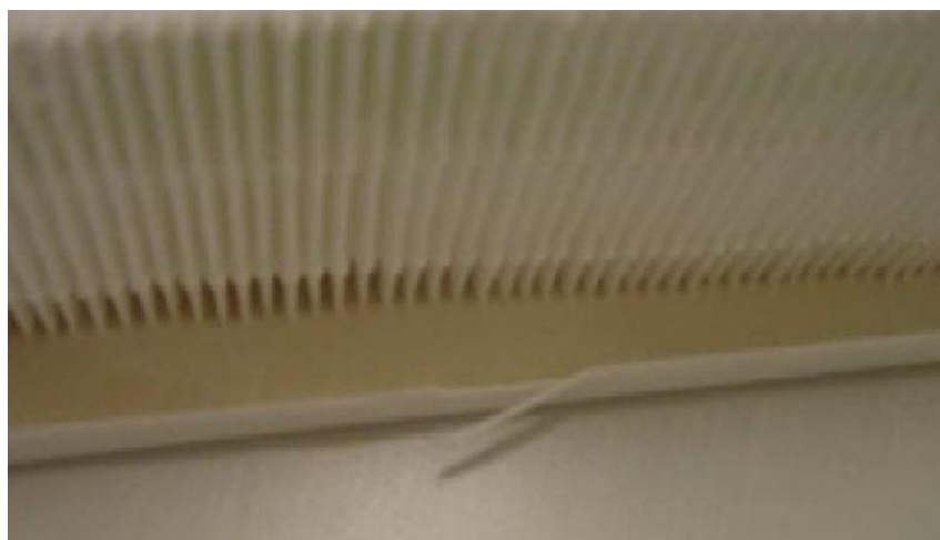
Рис.4.24. Скол пластмассы рамки фильтра после испытаний в климатической камере
