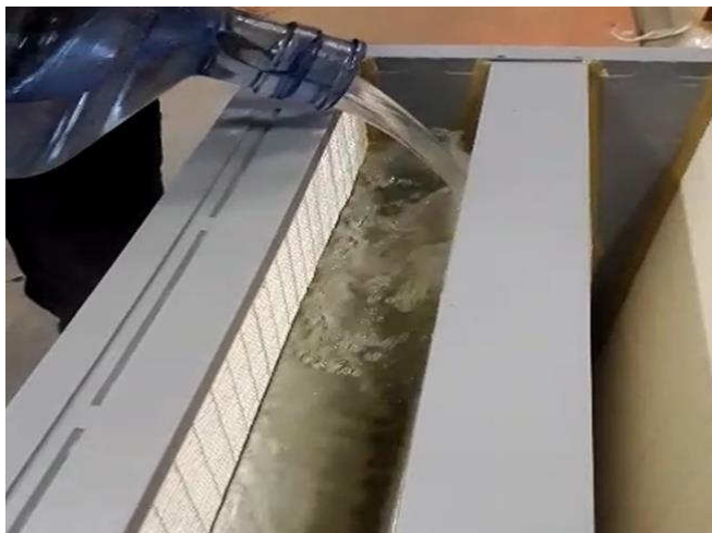
Рис. 4.29. Тест на водостойкость фильтра MVX F9
