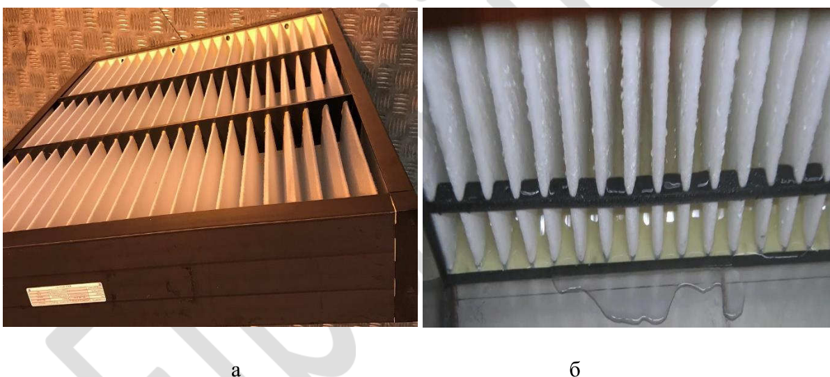
Рис.3.43. Панельные фильтры: а- образец E; б- образцы M1 и M2
