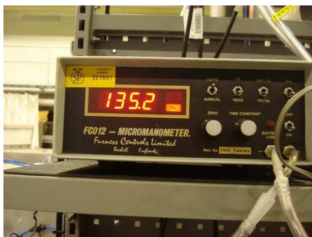
Рис.4.35. Начальный перепад давления фильтра E10-31/38, зафиксированный во время тестирования
