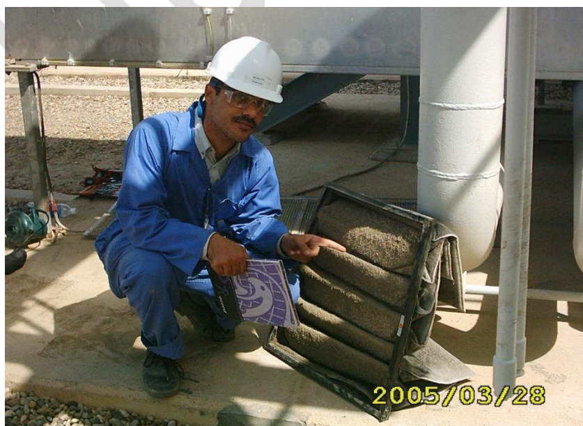
Рис.3.1. Карманный фильтр заблокирован песком (Ирак) [2]
