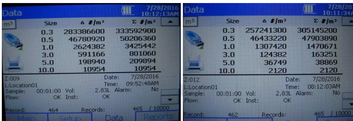
Рис. 2.10. Количество взвешенных частиц в 1 м 3 атмосферного воздуха на всасе КВОУ ТЭЦ в ЮАО (а), ТЭЦ в ЗАО (б)
