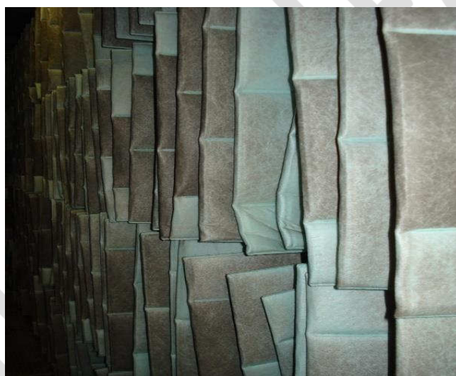
Рис.3.54. Неравномерное распределение пыли по карманам фильтра компании E
